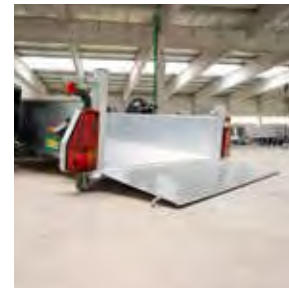
Flacher Auffahrwinkel mit 5°
