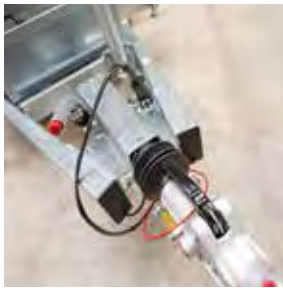
Rahmen aus geschweißtem Hohlprofil für Stabilität
